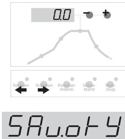
Drücken Sie die Taste **select** (7) und halten sie für ca. 3 Sekunden gedrückt. Die TC503 springt in die Konfiguration und zeigt den ersten Parameter der Liste (s. vorhergehende Seite). Auf der Anzeige (1) erscheint hierbei die Parameter-Nummer, auf Anzeige (2) der aktuelle Wert. Über die Tasten (4) und (5) können Sie alle Parameter der Liste anwählen und ggf. über die Tasten (8) verändern.
